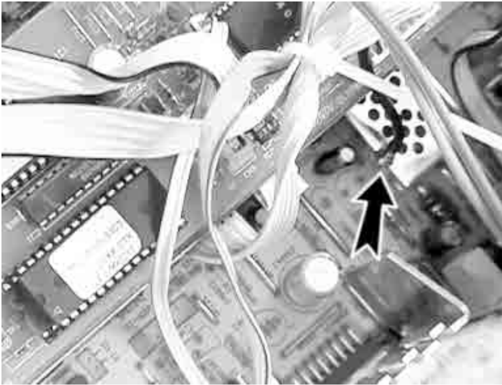
Masseleitung anlöten / Solder on ground cable
